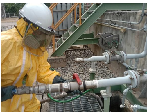
ภาพที่ 2-31 การสูบน้ำแอมโมเนียมไฮดรอกไซด์เหลว
