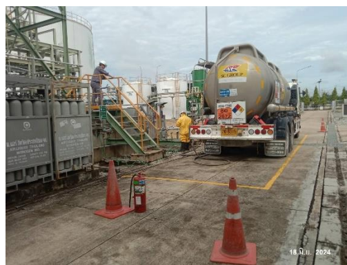
ภาพที่ 2-31 การสูบน้ำแอมโมเนียมไฮดรอกไซด์เหลว
